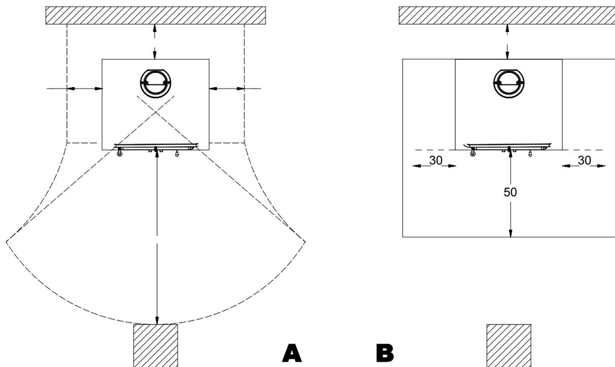
Všechny minimální bezpečné vzdálenosti (cm) jsou uvedeny na typovém štítku výrobku a NESMÍ se klesnout pod stanovené hodnoty (viz **PROHLÁŠENÍ O VÝKONU**).
