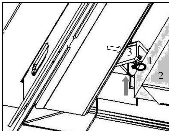
Pri montáži je postup opačný, doporučujeme si odskúšať zloženie deflektorov mimo krbovej vložky!
