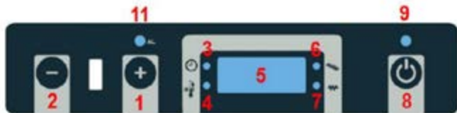
Abb. 8 Steuerpanel des Heizgerätes RAFAEL - Beschreibung
