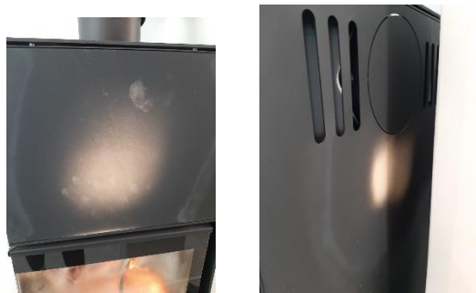
Rysunek 10. Przykłady przebarwień powstałych w wyniku przegrzewania urządzenia.
